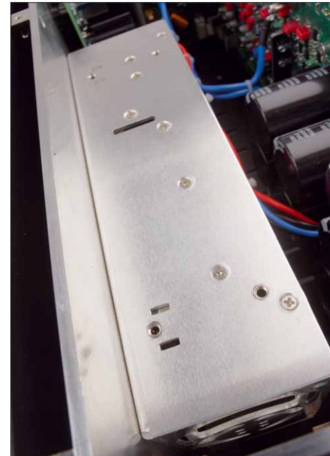
Ein erfreulich leichtgewichtiger Ersatz für einen voluminösen Ringkerntrafo ist dieses Schaltnetzteil in der Endstufe
